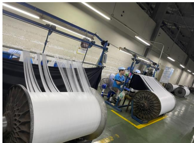
Công đoạn sang chỉ sợi dọc
