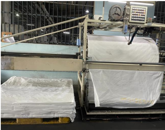
Công đoạn xả vải
